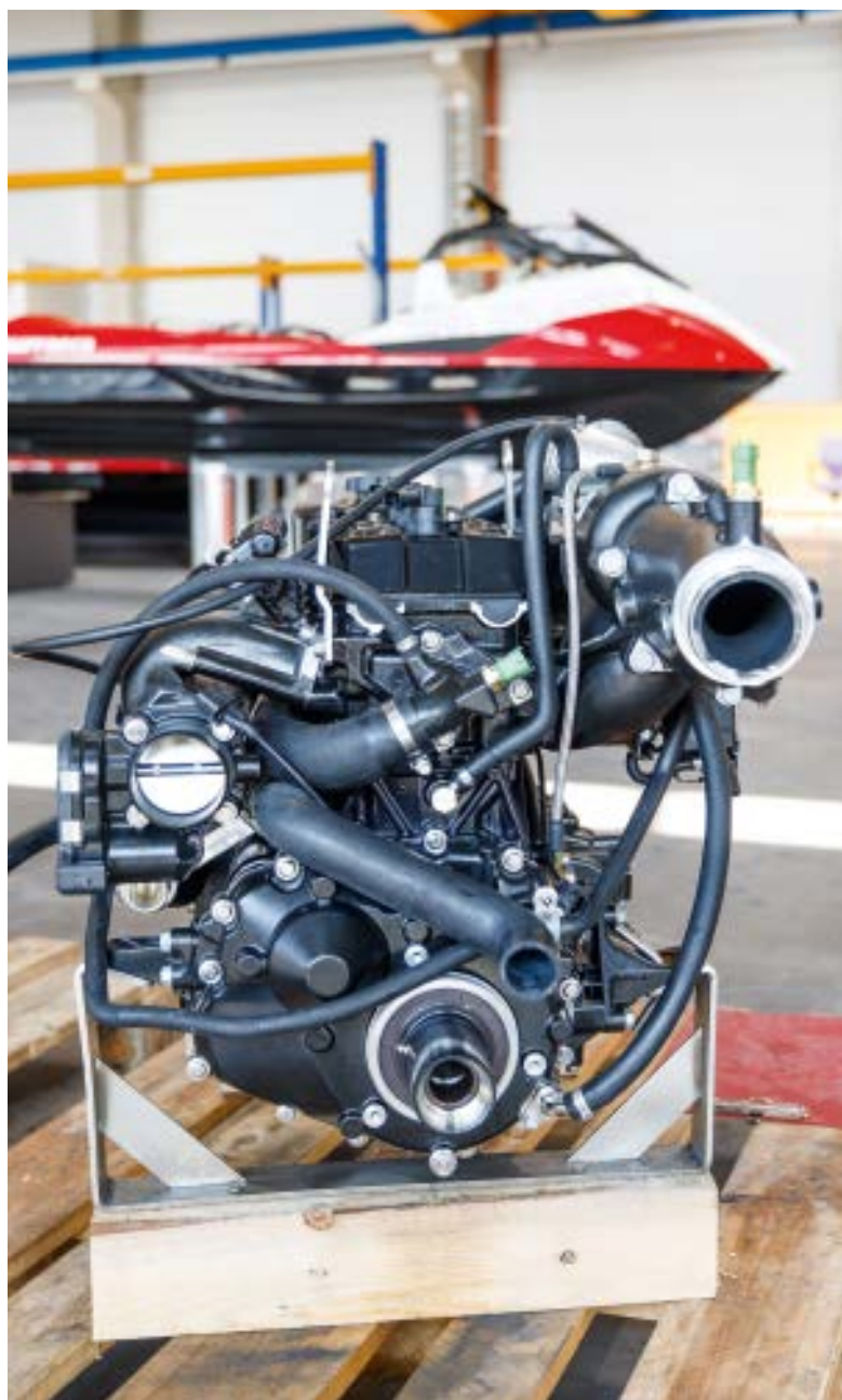
Herzstück des Burrasca ist der selbst entwickelte 320 PS starke Motor mit 1,6 l Hubraum.
