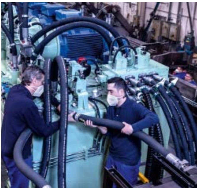
Eine leistungsstarke Hydraulik bildet das Herzstück der Ballenpressen von Imabe Iberica. Die Presskraft variiert je nach Material und Anwendung.
