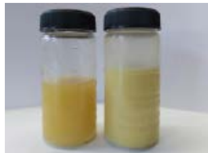
Abbildung 4: Mineralöl links, DOT mit erhöhtem Wasseranteil rechts
