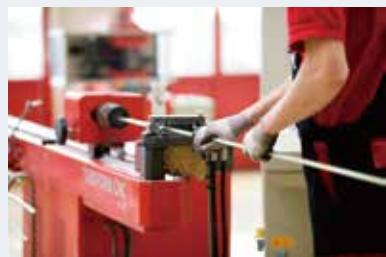
HANSA-FLEX弯管中心可准确、快速地提供各种弯管的设计、生产制造，可以根据客户图纸、3D数据、样品管或三坐标测量数据进行生产。
